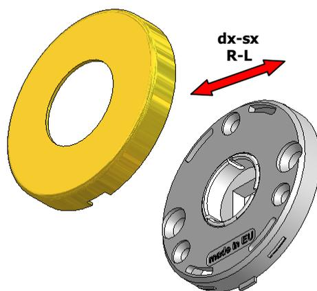
Ejemplo de montaje de una roseta  $\varnothing$  50x7 mm con muelle de retorno con una tapa  $\varnothing$  50x7 mm de latón.
